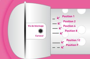
Des roues sont disposées aux extrémités des cylindres pour éviter l'écrasement des croquettes extraites. Elles sont munies d'une bande de roulement en caoutchouc pour éviter le bruit. L'appareil possède, en fonction du nombre et de la position des trous des deux cylindres, 5 niveaux de distribution permettant de libérer 1, 2, 4, 8 ou 12 croquettes ou granulés par tour, soit environ 3, 6, 12, 24 ou 36 croquettes ou granulés par mètre de déplacement.
